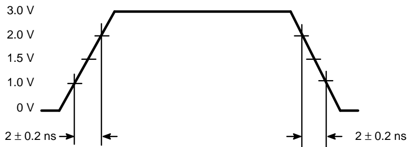
TTL Input Waveform
