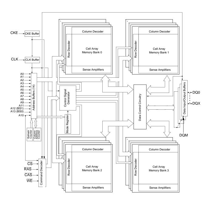
Cell Array for 4Mb x 4 DQ x 4 Bank (per Bank): 4096 Row x 1024 Col x 4 DQ (DQ0-DQ3). Cell Array for 2Mb x 8 DQ x 4 Bank (per Bank): 4096 Row x 512 Col x 8 DQ (DQ0-DQ7). Cell Array for 1Mb x 16 DQ x 4 Bank (per Bank): 4096 Row x 256 Col x 16 DQ (DQ0-DQ15).
